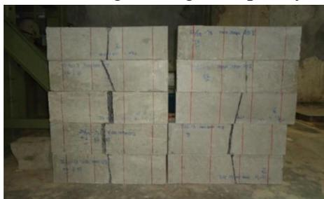
Karena retakan yang terjadi di permukaan balok bagian tarik atau bawah tepat berada pada daerah tengah bentang, maka *modulus of rupture* dihitung dengan rumus sebagai berikut :
