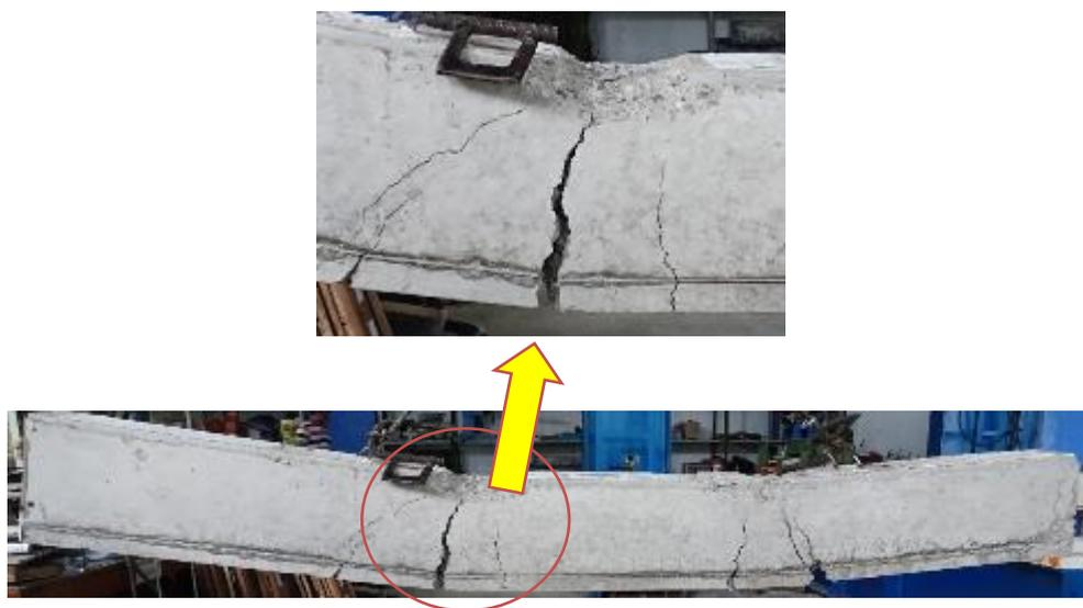
Gambar 7. Pola Retak dan Keruntuhan Balok Galvalum
