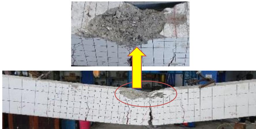
Gambar 6. Pola Retak dan Keruntuhan Balok Normal
