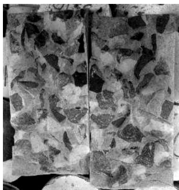
Gambar 4. Potongan beton setelah pengujian
