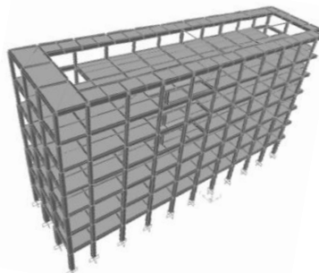
Gambar 2. Pemodelan Gedung Lantai 7 dengan software struktur
