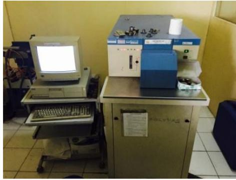
Gambar 1. Alat uji komposisi (spektrometer) dan data hasil pengujian
