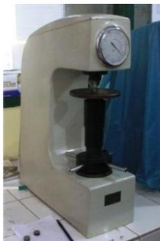
Gambar 3. Alat uji kekerasan
