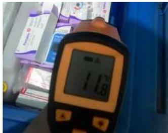
Gambar 1. Pengukuran suhu pada vaksin DPT adalah 11,8°C. Standard: suhu refrigerator dalam rentang +2 s/d +8°C
