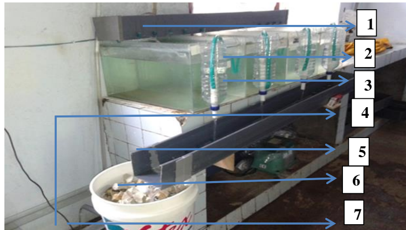
Gambar 7. Design Sistem Resirkulasi dengan Filter Zeolite Dan Dacron Silikon
