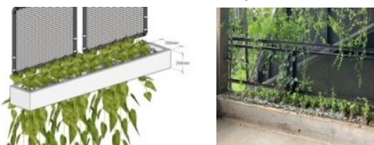
Gambar 4.10 Media Tanam Green Wall Fasad Depan Sumber: Analisa Pribadi, 2021
