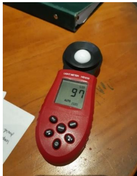
Gambar 18. Pengukuran Sample Lampu Menggunakan Luxmeter Sumber: Dokumentasi Penulis
