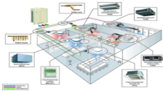
Gambar 9 Skema AC VRV Sumber : www.nec.com
