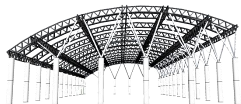
Gambar 30. Model Struktur Space Beam pada atap Exhibition hall Sumber : Penulis, 2012
