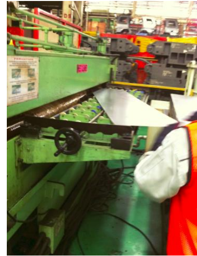
Gambar 4.5 Material Dibersihkan dengan Mesin Sheet Cleaner
