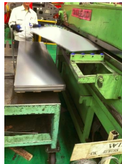
Gambar 4.6 Material Setelah Dibersihkan dengan Mesin Sheet Cleaner
