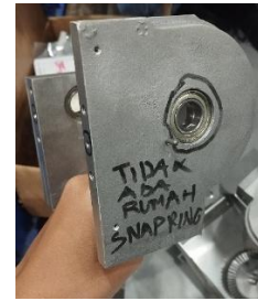
Gambar 4. 1 Gambar Defect Tidak Ada Rumah Sparing
