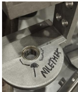
Gambar 4. 6 Gambar Defect Lubang Pada Gear Box Retak Setelah Diisi Snapping
