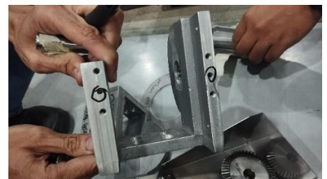
Gambar 4. 3 Gambar Defect Lubang Tempat Baut Tidak Center
