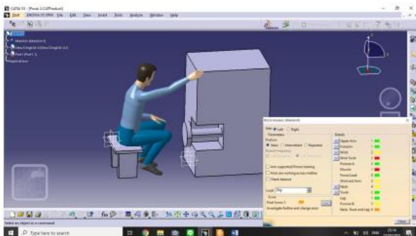
Gambar 4. 9 Nilai RULA Pada Postur Kerja Pekerja Pengepress Kayu (Sisi Kiri) sebelum perbaikan
