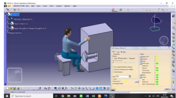
Gambar 4. 10 Nilai RULA Pada Postur Kerja Pekerja Pengepress Kayu (Sisi Kanan) setelah perbaikan
