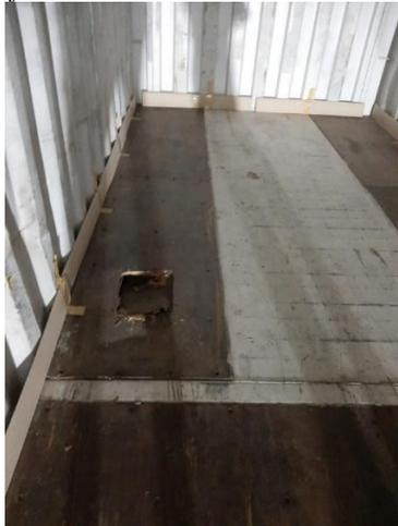
**Gambar 9.** Lantai *Container* Rusak Tepat Pada Jalur Roda *Forklift*
