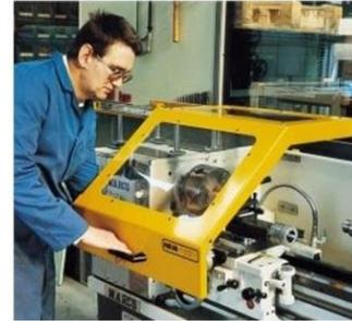
**Gambar 5.8 Pemberian Pelindung Pada Mesin**
