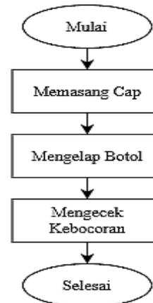
**Gambar 5. Penambahan SOP pada *Reject* Produk Rembes**
