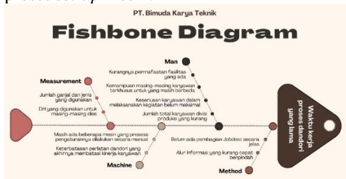
Gambar 3. Diagram Fishbone Proses Set-up Ada 4 faktor yang berpengaruh secara signifikan pada proses dandori PT. Bimuda Karya Teknik. Faktor-faktor tersebut antara lain:
