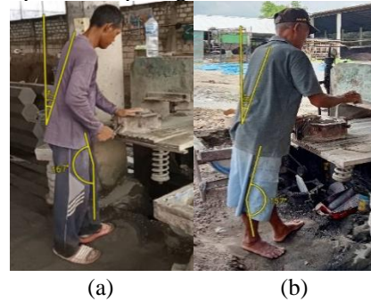
(a) (b) Gambar 16 Membuka Pengunci pada Tempat Cetakan (a) Pekerja 1 (b) Pekerja 2
