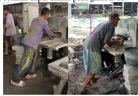
Gambar 13 Mendorong Tempat Cetakan ke Mesin untuk Memadatkan Adukan Paving Block (a) Pekerja 1 (b) Pekerja 2
