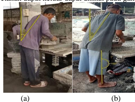
(a) (b) Gambar 17 Mengangkat Tempat Cetakan supaya Hasil Cetakan Paving Block dapat Keluar (a) Pekerja 1 (b) Pekerja 2
