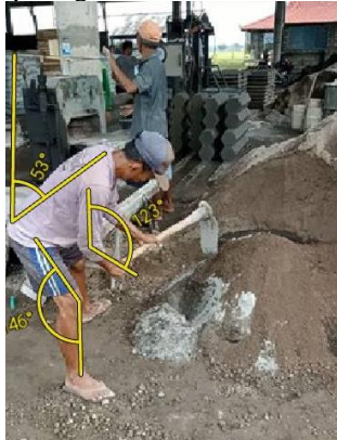
Gambar 9 Mengaduk Adukan Paving Block
