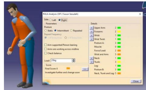
Gambar 6. Hasil RULA Posisi Akhir Menyusun Karung Operator 2
