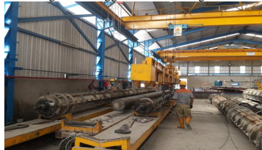
Gambar 7. Hoist lama untuk proses pengeluaran produk
