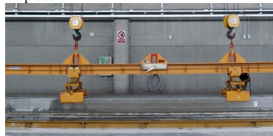
Gambar 7. Hoist lama untuk proses pengeluaran produk
