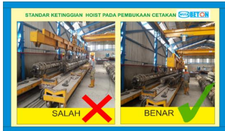
Gambar 5. Desain visual display pada pekerjaan mengangkat cetakan dari trostel uap atau bak uap pada proses pengeluaran produk beton
