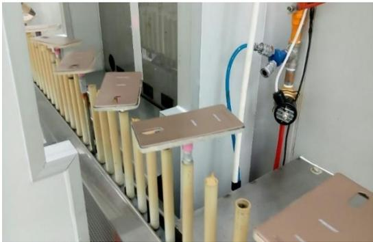
Gambar 4 Jig-Jig pada Konveyor Mesin-Mesin Coating
