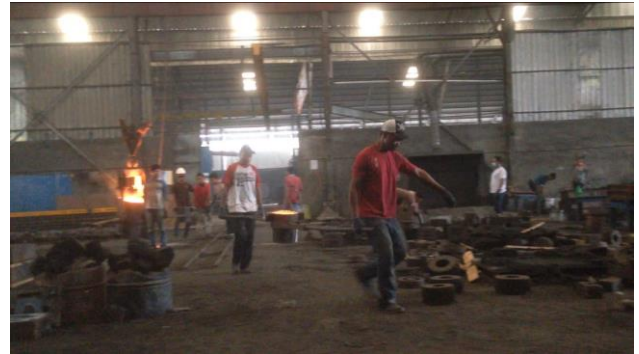
Gambar 4.3 Proses membawa hasil leburan menggunakan tungku kecil ke bagian molding dengan manual
