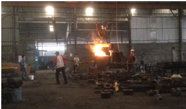
Gambar 4.1 Proses pemindahan tungku masak dengan menggunakan crane
