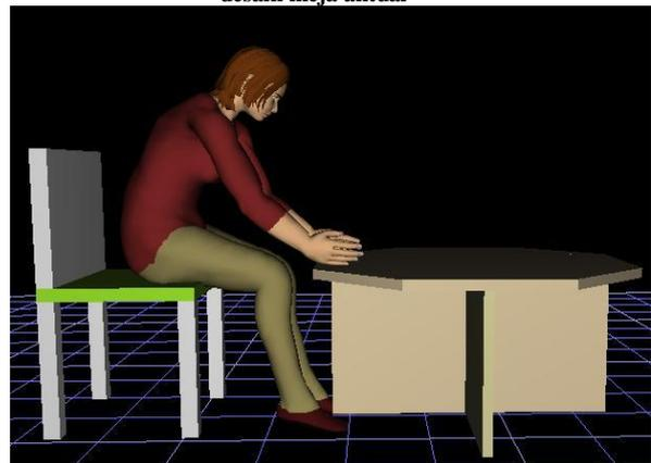
Gambar 6: Postur wanita persentil 5 (konfigurasi 2) pada desain meja aktual
