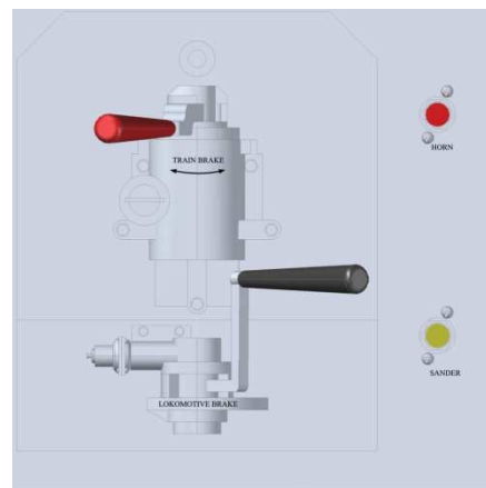
Gambar 10. Labeling Pada Kontrol
