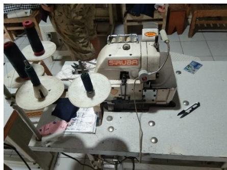
Gambar 4 Mesin Jahit Obras 4 atau 5 Benang. Sudah digunakan sejak tahun 2014. Sumber: Dokumentasi peneliti, Tahun 2022.
