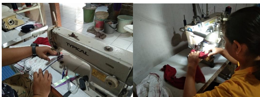
Gambar 5 Sebelah kiri adalah mesin jahit jarum 1 dan sebelah kanan mesin jahit overdeck. Peralatan ini sudah digunakan sejak tahun 2014. Sumber: Dokumentasi peneliti, Tahun 2022.
