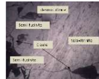
Gambar 4 Kenampakan sayatan polished block seam rove 2 dibawah mikroskop polished sinar pantul dengan 200 kali pembesaran (Tekmira, 2013)
