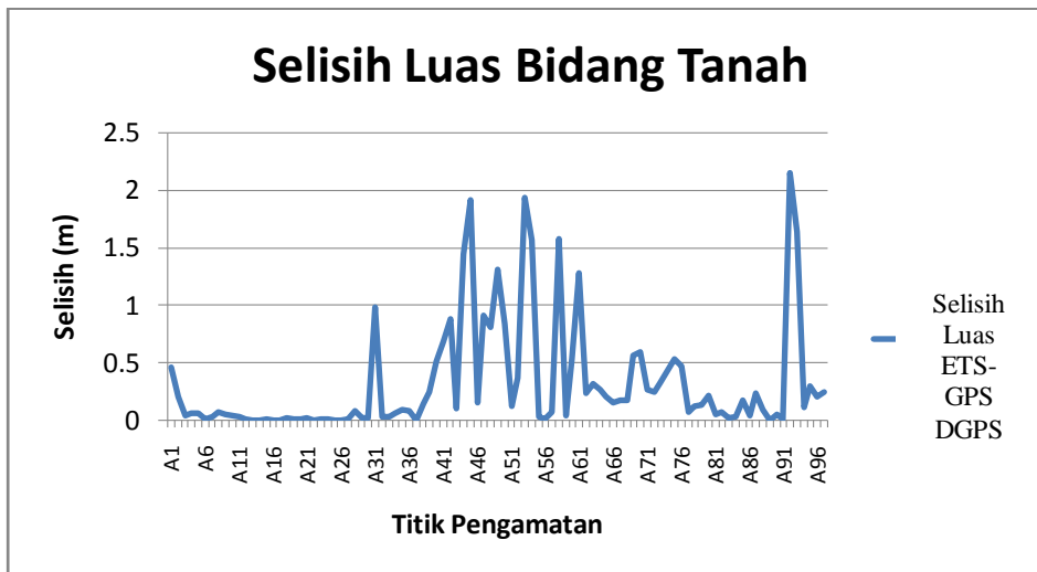
Gambar 5. Grafik Perbedaan Luas Bidang Tanah antara ETS dan Receiver Trimble Metode DGPS
