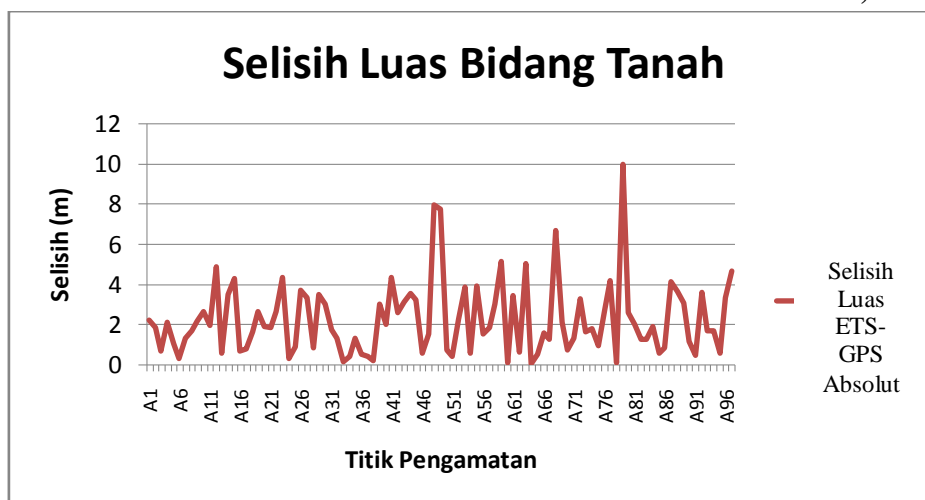
Gambar 4. Grafik Perbedaan Luas Bidang Tanah antara ETS dan Receiver Trimble Metode Absolut
