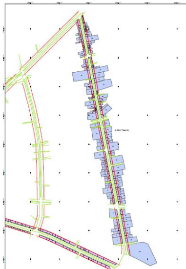
Gambar 5 Hasil Evaluasi Tata Letak Bangunan Terhadap Garis Sempadan Jalan Di Jalan Gajahmada
