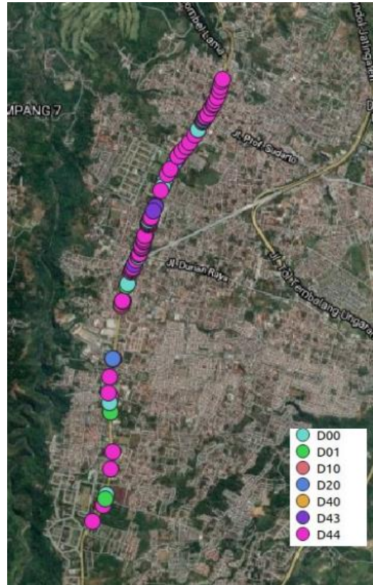
Gambar 9 Persebaran Hasil Identifikasi Kerusakan Jalan di Jalan Setia Budi sampai Jalan Perintis Kemerdekaan
