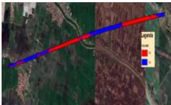
Gambar IV-5 Hasil cut and fill DEM kala 1 dan 2
