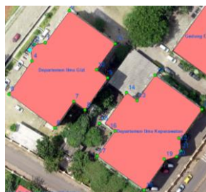
Gambar 14 Hasil digitasi pengolahan foto udara secara tegak
