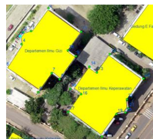
Gambar 15 Hasil digitasi pengolahan foto udara secara oblique
