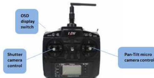
Gambar 5. Fungsi kerja stick kontrol pada radio transmitter 7 channel (sistem kendali kamera)
