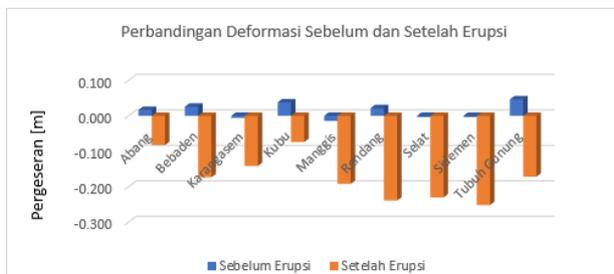
Gambar 5 Perbandingan Deformasi Sebelum dan Setelah Erupsi
