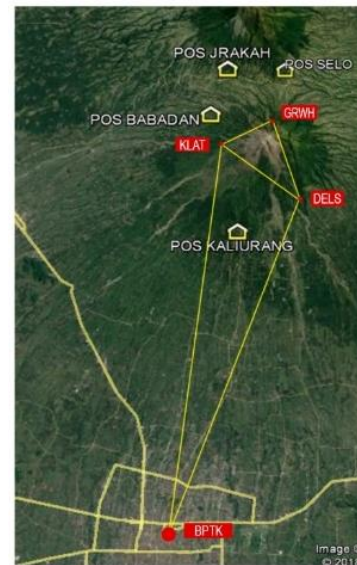
Gambar 3 Skema pengukuran GPS Geodetic di daerah sekitar puncak Merapi (Google Earth)
