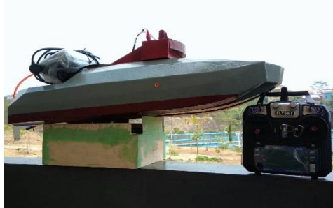
Gambar III.2 Kapal Quadmaran siap untuk pemeruman
