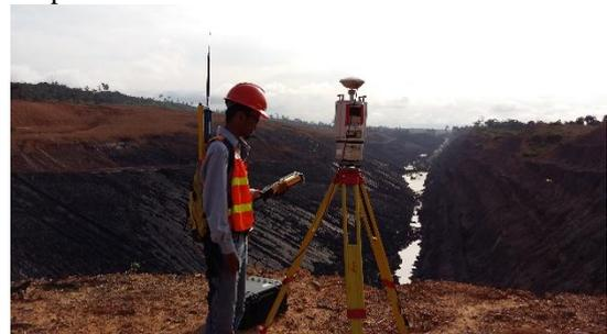
Gambar 1 TLS *Riegl VZ-1000* dan *GNSS Trimble R5 TSC3*
