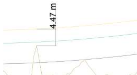
Gambar 16. Jarak objek berbahaya pada ruang bebas
