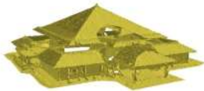
Gambar 11 Hasil Filtering dan Meshing Gedung Prof. Sudarto S.H
