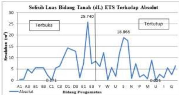
Gambar 12. Grafik selisih luas bidang tanah (dL) ETS terhadap metode absolut
