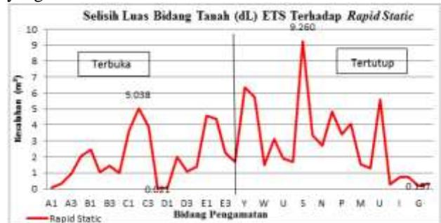
Gambar 13. Grafik selisih luas bidang tanah (dL) ETS terhadap metode *rapid static*
