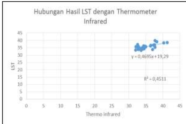
Gambar 18 Hubungan antara suhu pengolahan LST dengan suhu lapangan dengan thermometer infrared
