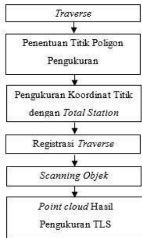
Gambar III-4 Diagram alir metode Traverse
