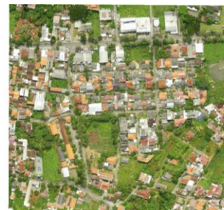
Gambar IV.1. Hasil Orthofoto Plan 1 Menggunakan DroneDeploy Dashboard
