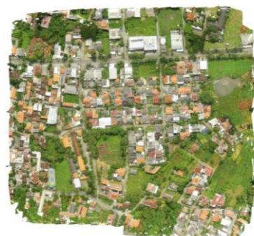
Gambar IV.2. Hasil Orthofoto Plan 1 Menggunakan Agisoft PhotoScan
