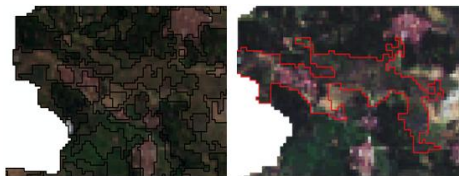
Gambar IV.7 Segmentasi yang Mengalami Over Segmentation (kiri) dan Under Segmentation (kanan)
