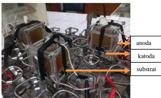
Gambar 1. Desain bioreaktor MFC *single chamber*
