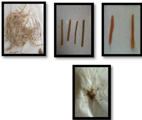
Gambar 3. Makroskopis : jerami (i) sebelum direndam (ii) kontrol (iii) setelah perendaman (iv) dengan air sawah selama empat minggu.
