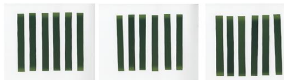
Gambar 1.3 Hasil film gafchromic untuk sudut 15°, 30°, dan 45°
