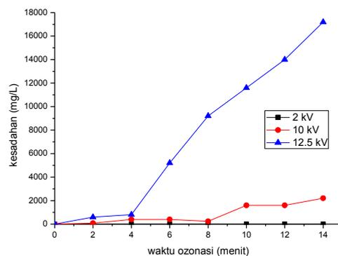
**Gambar 5.** Grafik karakteristik kesadahan ( $CaCO_3$ ) terhadap waktu ozonasi pada tegangan 2 kV, 10 kV, dan 12,5 kV menggunakan kecepatan aliran udara 1,5 L/menit
