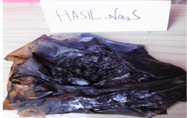
Gambar 3. Pengambilan Endapan yang Dihasilkan dari Metode Pengendapan dengan  $\text{Na}_2\text{S}$ .
