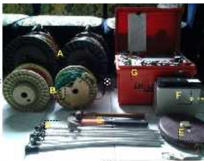
Gambar 2 Alat pengukuran, (a) Kabel arus, (b) Kabel potensial, (c) Palu, (d) Elektroda, (e) Meteran, (f) Accu , (g) Naniura
